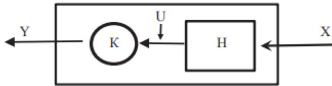
Ответы: 1). поток обслуживания 2). выходной поток 3). канал обслуживания 4). входной поток 5). накопитель с заданными параметрами
