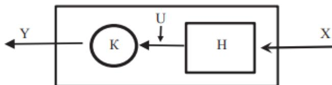
Ответы: 1). входной поток 2). накопитель с заданными параметрами 3). поток обслуживания 4). выходной поток 5). канал обслуживания
