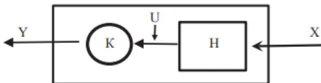
Ответы: 1). накопитель с заданными параметрами 2). выходной поток. 3). поток обслуживания 4). канал обслуживания 5). входной поток
