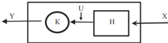
Ответы: 1). поток обслуживания 2). канал обслуживания 3). входной поток 4). выходной поток. 5). накопитель с заданными параметрами
